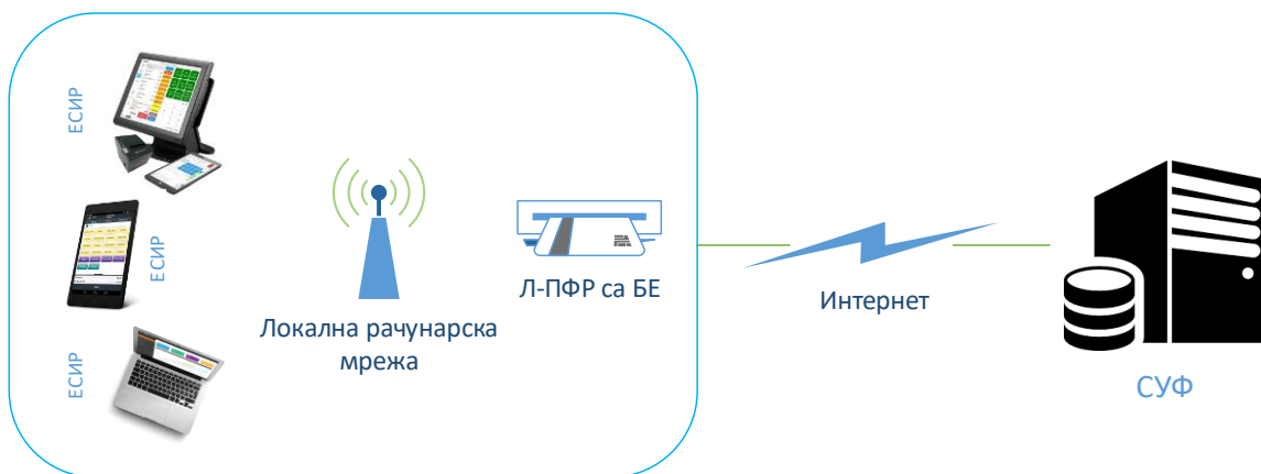
Слика: Један или више софтверских ЕСИР-а, инсталираних на личном рачунару, мобилном телефону или таблети, који се преко локалне мреже повезују са једним Л-ПФР-ом
